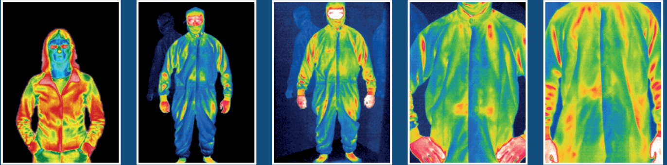
Thermoaufnahmen belegen, dass sich über einen bestimmten Zeitverlauf Wärme unter der Reinraumberbekleidung aufstauen kann
