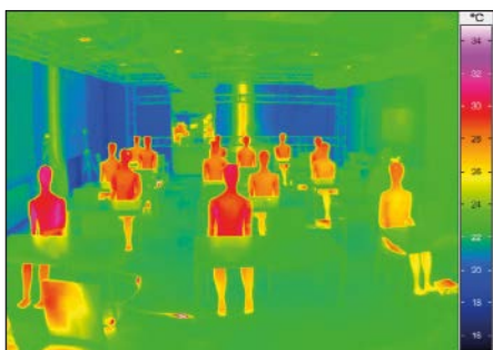
Mit beheizten, atmenden Modellen wird am DLR-Institut für Aerodynamik und Strömungstechnik in Göttingen ein vollbesetzter Klassenraum nachgestellt.
